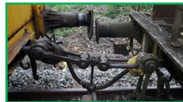
A défaut, lorsque la rame est déplacée, la partie avant du convoi avance déjà d'une quinzaine de centimètres, alors que les parties arrière ne se sont pas encore déplacées. Dès que l'attelage se tend, la partie arrière est brusquement mise en mouvement, provoquant des chocs importants aux attelages et au contenu des véhicules. Ces chocs peuvent entraîner des dégâts aux attelages (ruptures) ou au matériel transporté (renversement).
