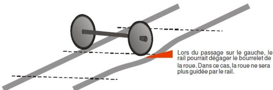
La tolérance pour un gauche est de 12mm d'écart vertical par rapport au rail voisin. Au-delà, un nivellement + bourrage devient nécessaire.
